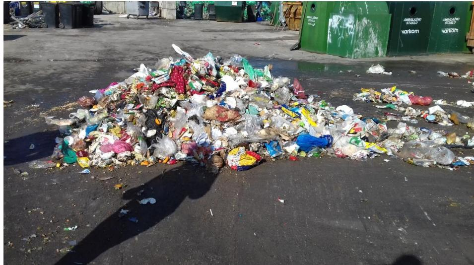
*Slika 24 Prikaz reprezentativnog uzorka nakon četvrtanja*
