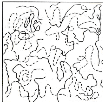
Slika 5. Mješljiva mješavina polimera A (puna linija) i B (iscrtkana linija)
