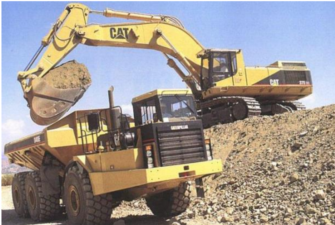
Slika 28 Bager s dubinskom lopatom [39]
