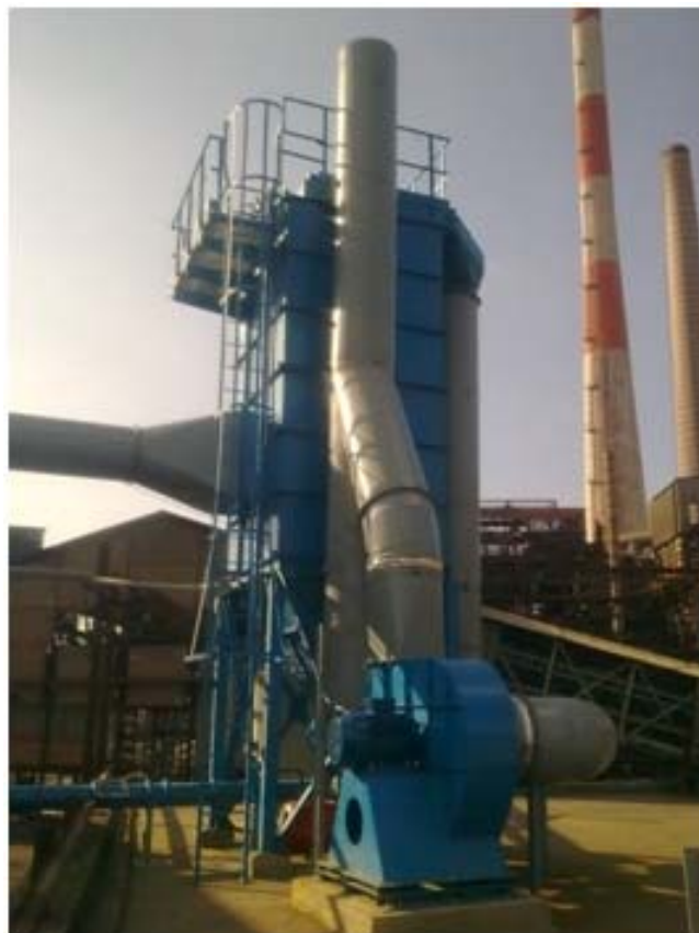
Slika 10 Vrećasti industrijski filter [20]
