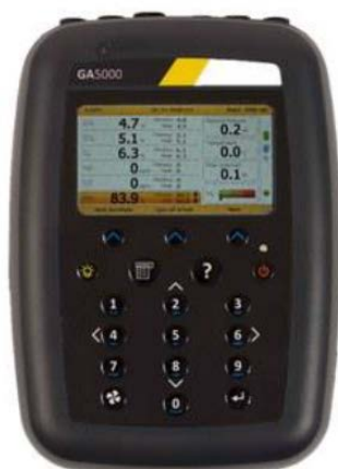
Slika 7. Analizator plina GA5000
