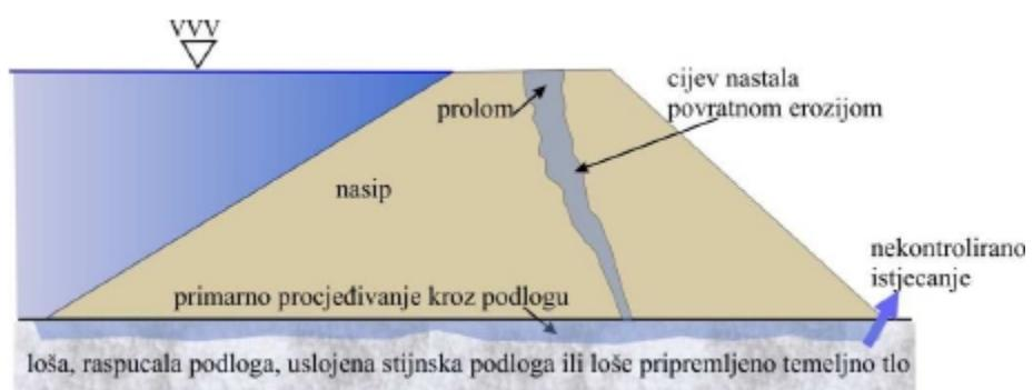
Slika 30. Povratna erozija kroz nasip uslijed ispiranja temeljnog tla [3]
