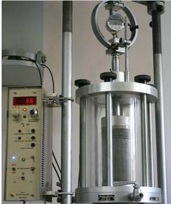
Slika 20. Uređaj za troosni posmik
