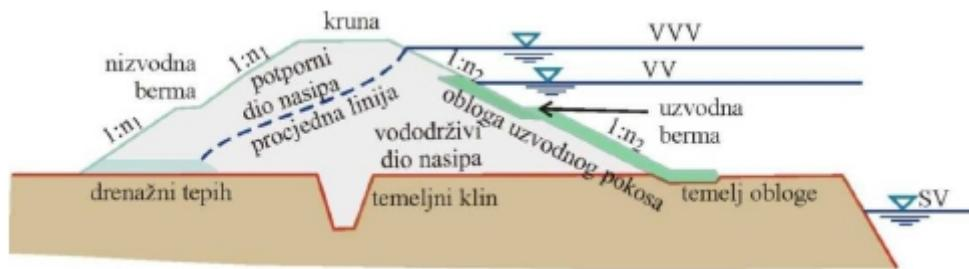
Slika 2. Hidrotehnički nasip [3]
