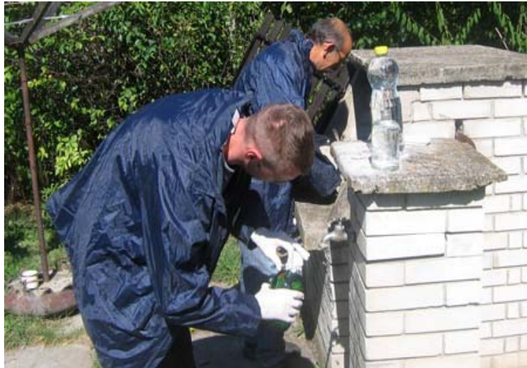
Slika 7. Uzimanje uzoraka vode iz zdenca [20]
