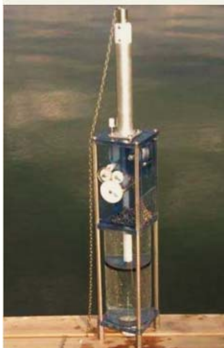
Slika 10. Uzorkivač na ispiranje [23]
