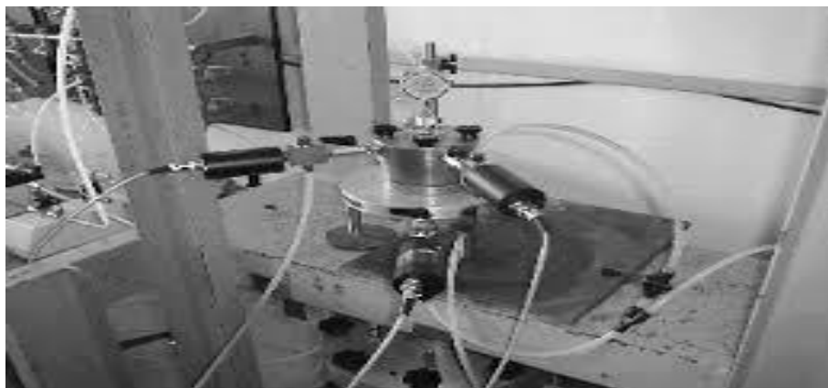
Slika 4. Laboratorijsko mjerenje koeficijenta propusnosti tla (Veinović, 2003)
