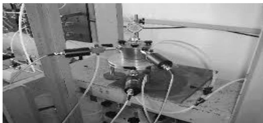
Slika 4.Laboratorijsko mjerjenje koeficijenta propusnosti tla(Veinović,2003)
