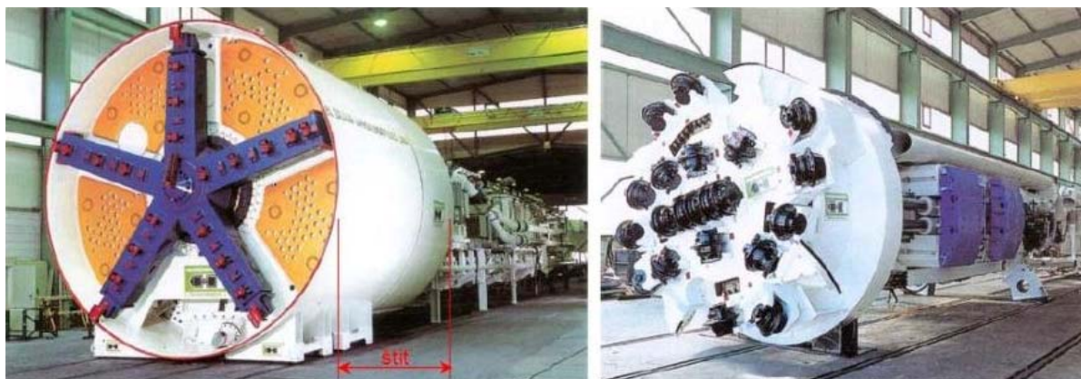
Slika 7.2 Stroj sa i bez štita
