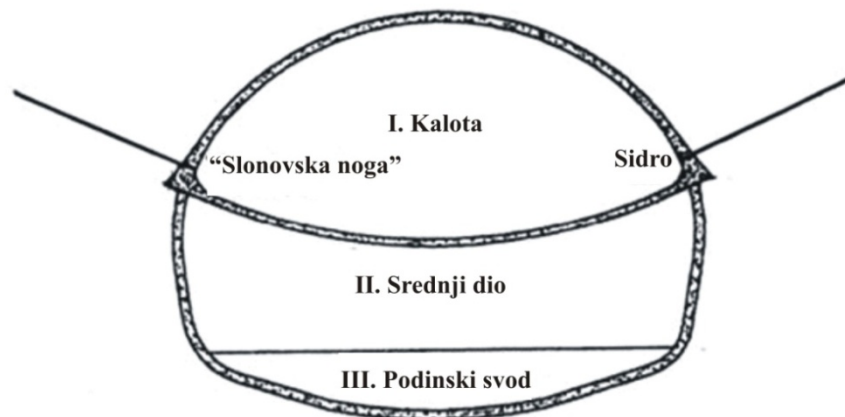
Slika 6.1 Iskop u tri faze [8]
