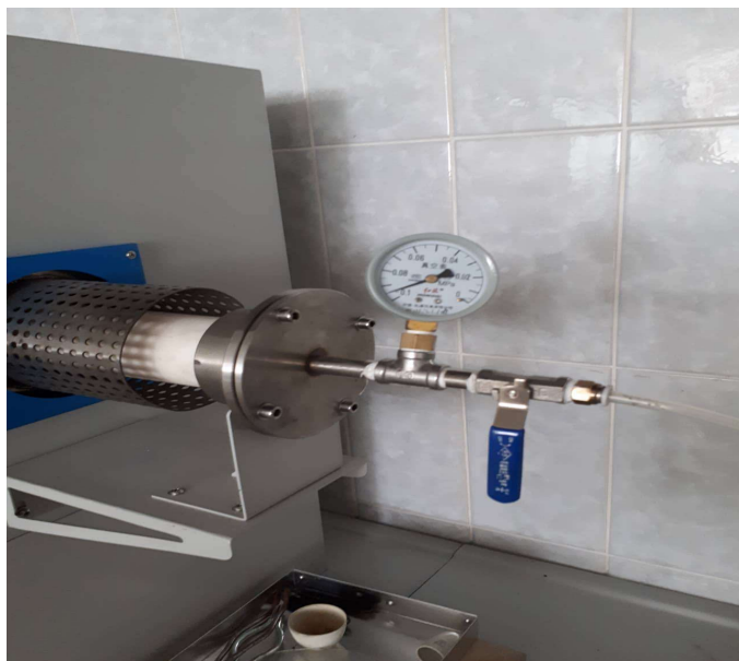
Slika 8: Ventil pomoću kojeg se upuhuje dušik
