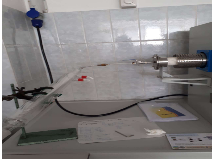
Slika 7: Ventil pomoću kojeg se ispuhuje zrak i stvara se vakuum
