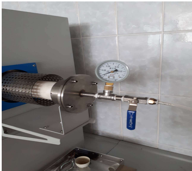
Slika 8: Ventil pomoću kojeg se upuhuje dušik
