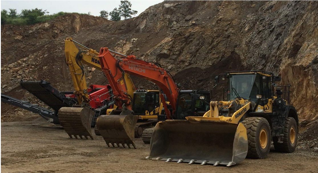
Slika 5.2 Bageri gusjeničari cikličkog načina rada i utovarivač [4]
