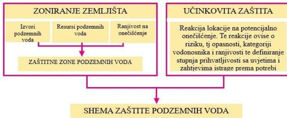
Slika 7. Shema zaštite podzemnih voda
