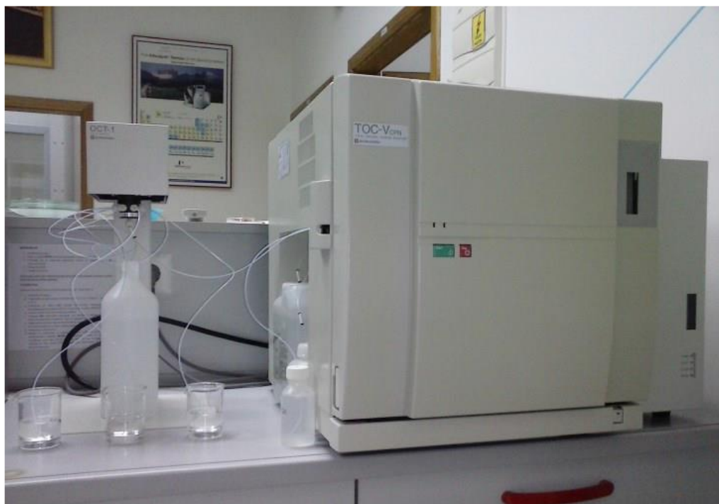
Slika 14 Uređaj za mjerenje ukupnog organskog ugljika- TOC/TN analizator
