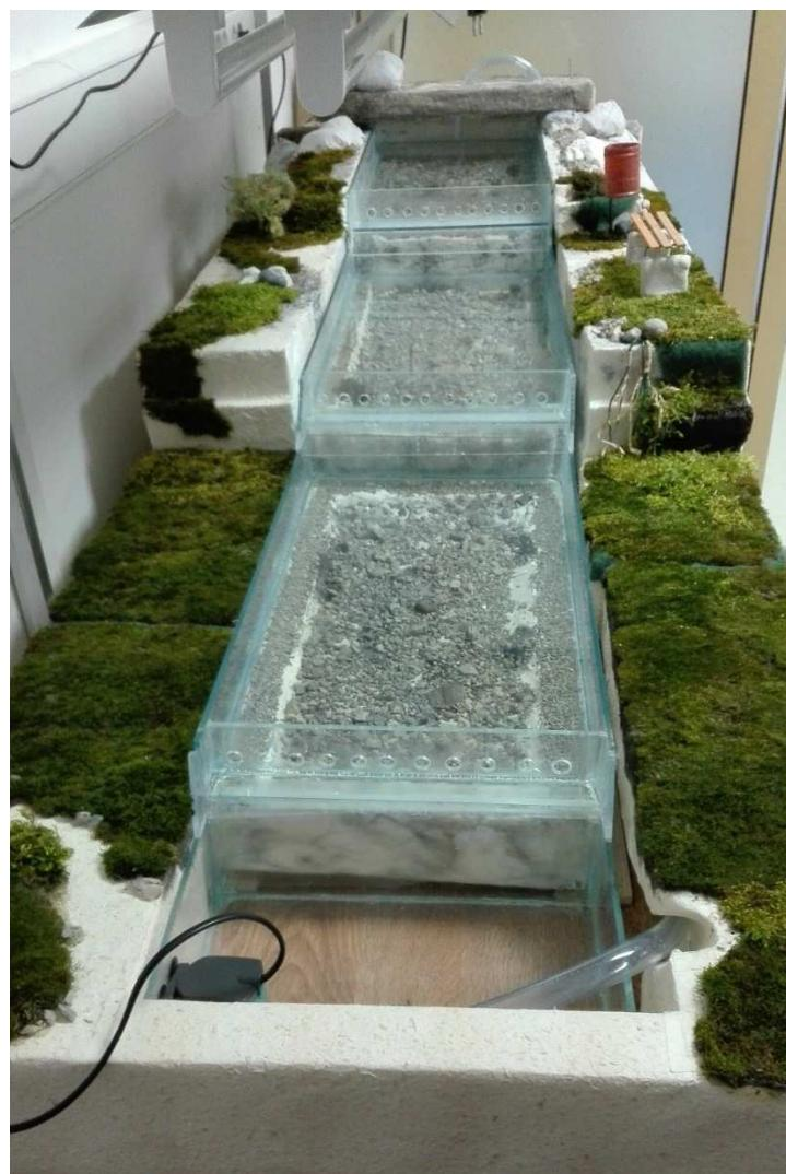
Slika 24 Eksperimentalni sustav pločastog kaskadnog reaktora Geotehničkog fakulteta
