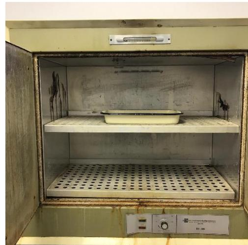
Slika 13. b) Sušenje uzorka u sušioniku
