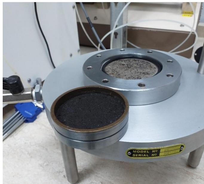
Slika 14. Slijeganje uzorka nakon provedenih ispitivanja
