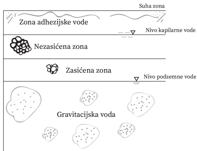
Slika 3. Gravitacijska i kapilarna voda u tlu
