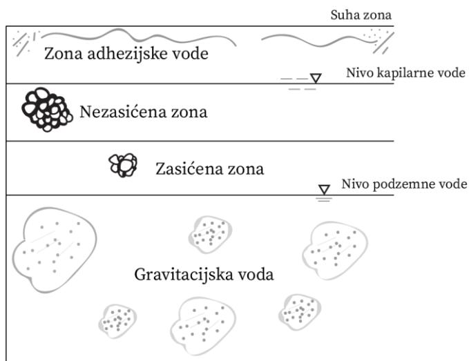
Slika 3. Gravitacijska i kapilarna voda u tlu
