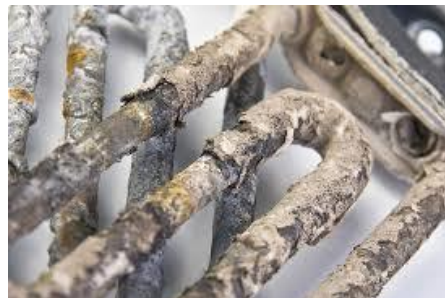
Slika 7. Taloženje kamenca na cijevima
