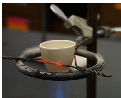
Slika 18. Žarenje u porculanskom lončiću
