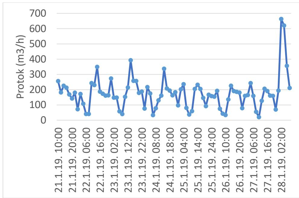
Slika 9 Protok vode na ispustu Poreč Sjever [23]
