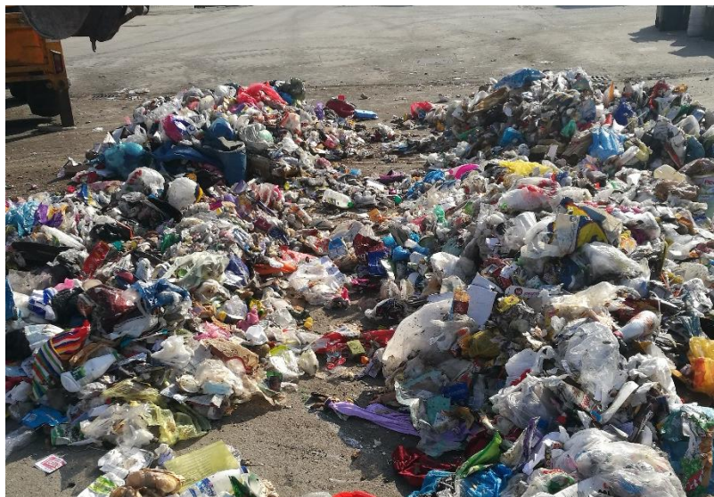
Slika 19 Prikaz četvrtanja otpada
