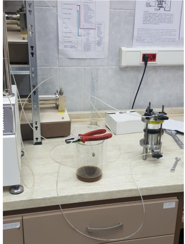
Slika 29. Toksična ćelija i procjedna voda iz uzorka
