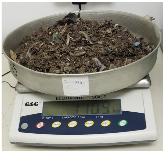
Slika 15. Vaganje posude i vlažnog uzorka
