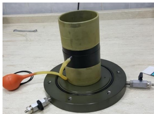
Slika 22. Pomoćni set za ugradnju rahlog uzorka
