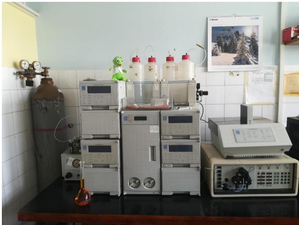
**Slika 6.** Ionski kromatograf DIONEX DX-500 (Thermo Scientific, SAD)
