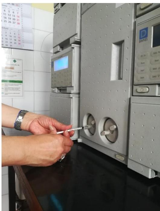
**Slika 7.** Injektiranje uzorka površinske vode kroz injekcijsku petlju ionskog kromatografa
