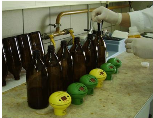
Slika 39. Priprema uzorka za ispitivanje BPK 5 [33]
