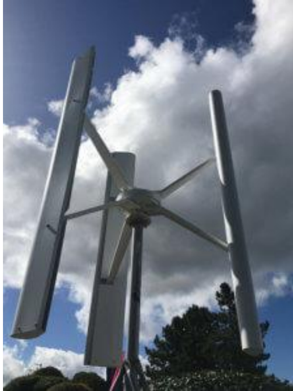
Slika 14. Prikaz vjetroelektrane s okomitim rotorom [23]
