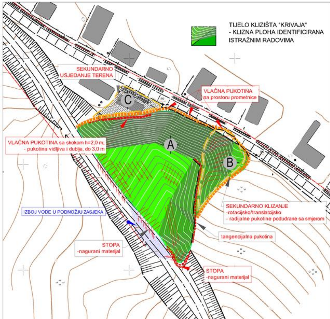
Slika 40. Podjela klizišta prema kinematici pomaka.
