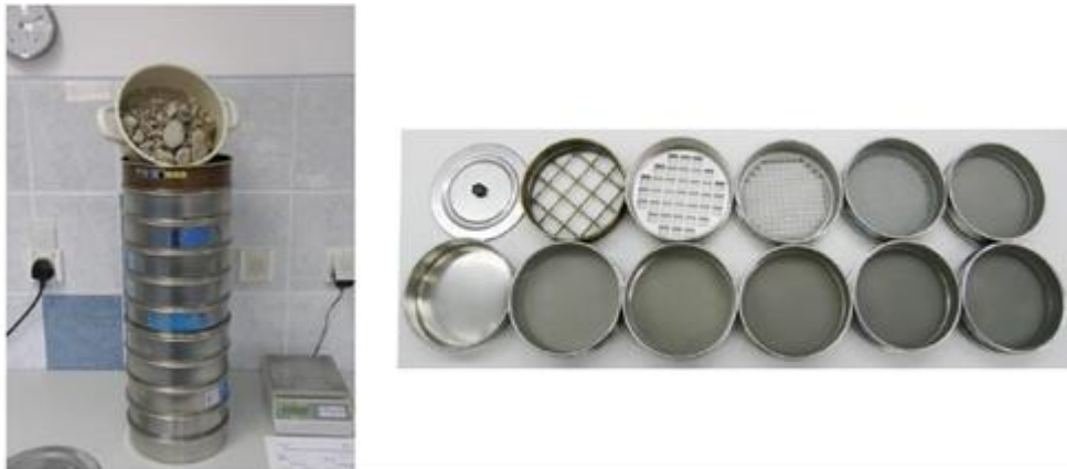
Slika 23. Mehanička tresalica sa odgovarajućim sitima različitih promjera otvora
