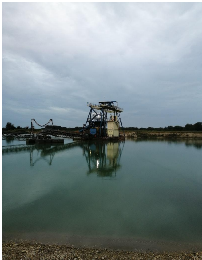
Slika br. 2: Plovni bager za iskop šljunka
