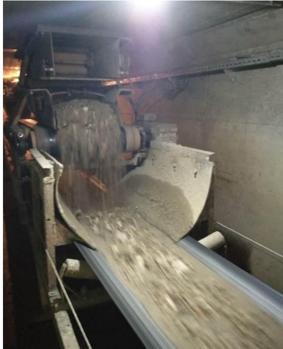
Slika br. 11: Dozator u separacijskom tunelu [10]
