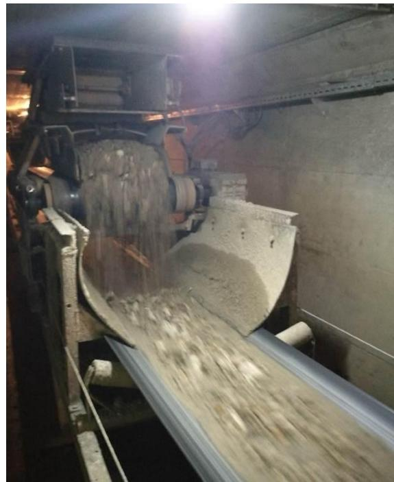
Slika br. 11: Dozator u separacijskom tunelu [10]
