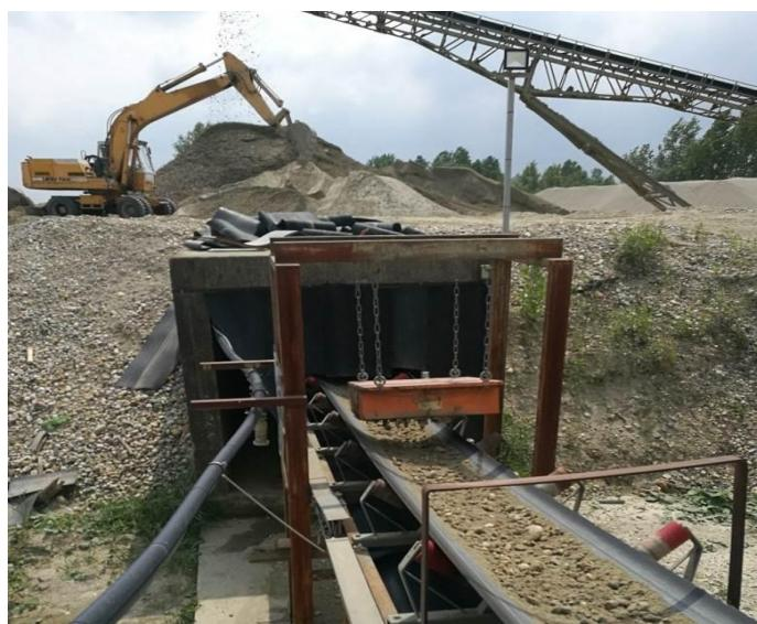
Slika br. 12: Izlaz iz separacijskog tunela [10]
