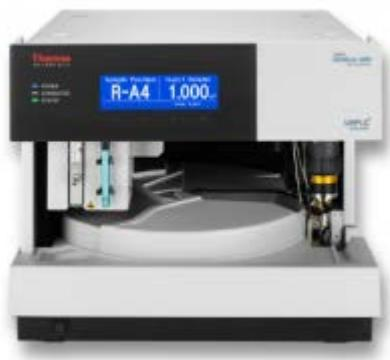
*Slika 11. Uređaj za tekućinsku kromatografiju*
