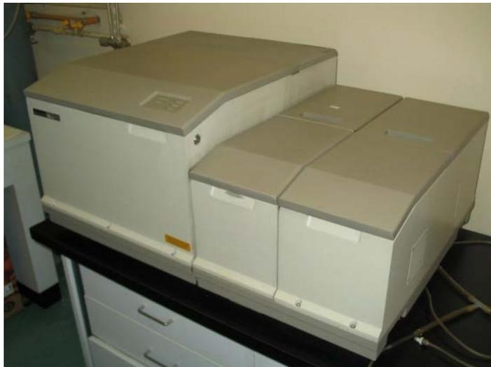
*Slika 12. Infracrveni spektrometar s Fourierovom transformacijom*
