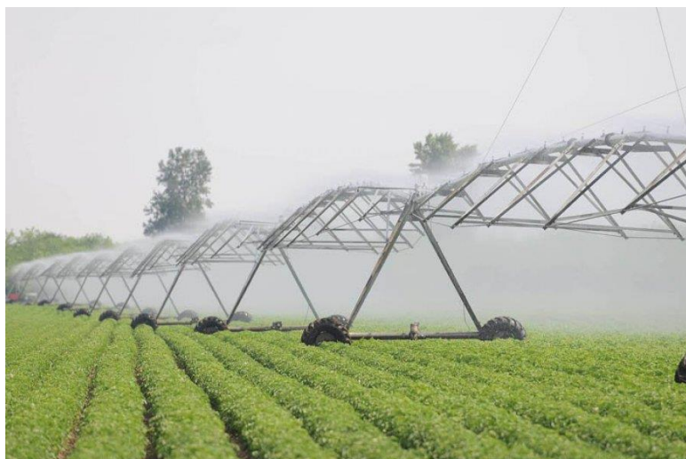
Slika 9. Navodnjavanje graška linijskim pokretnim sustavom navodnjavanja [8]
