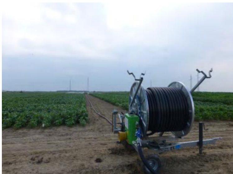
Slika 7. Samohodni vučeni rasprskivač (Tifon) s kišnim krilom, navodnjavanje pokusa [1]
