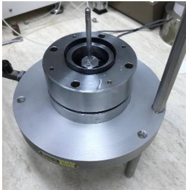
Slika 14 Postavljanje uzorka u hidraulički edometar
