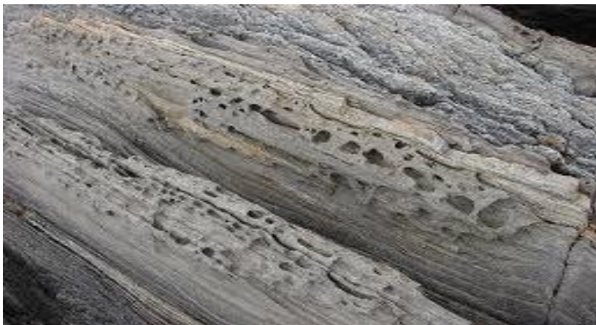
Slika 4. Raspadanje stijene zbog pojave škriljavost
