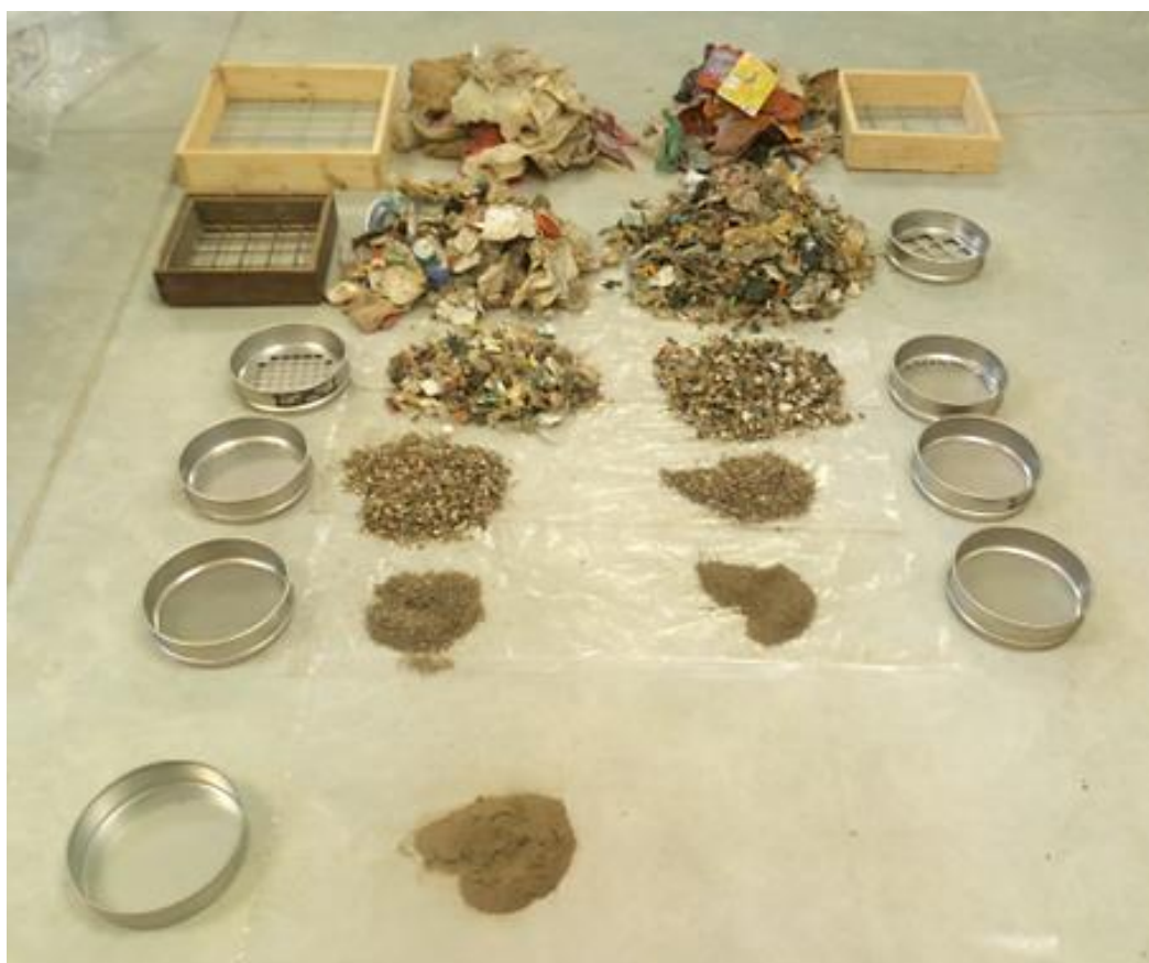
Slika 3.7.: Sita i prosijani uzorak iz ŽCGO Kaštijun
