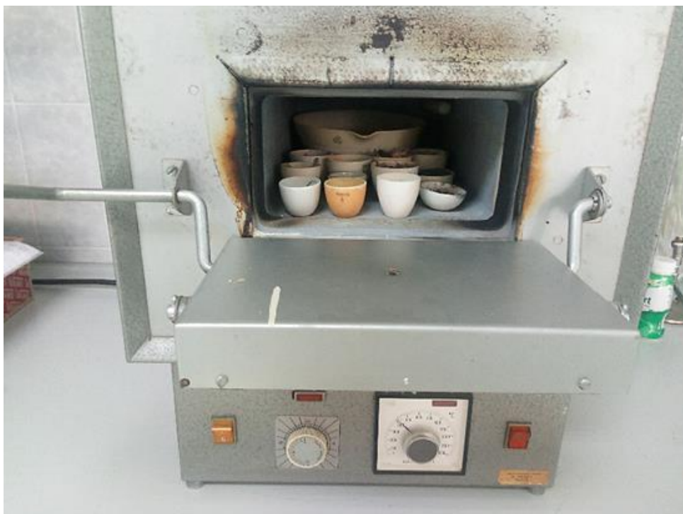
Slika 3.5.: Uzorak u peći za žarenje
