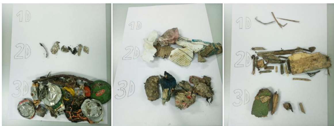
Slika 3.6.: Komponente uzorka iz ŽCGO Kaštijun razdvojene prema obliku (s lijeva na desno: metali, papir i karton, drvo)
