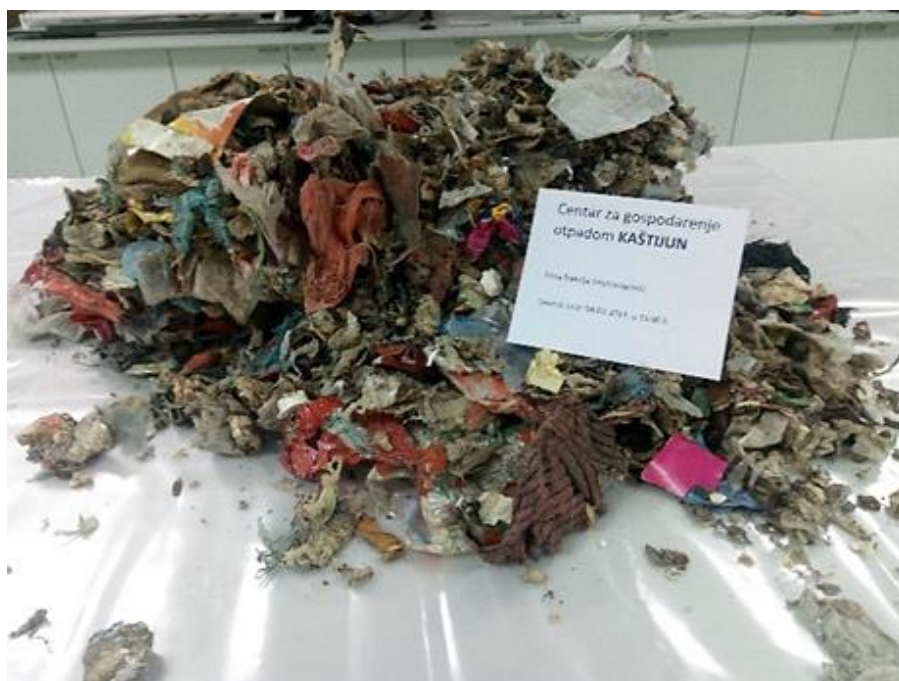
Slika 3.1.: Uzorak sitne frakcije komunalnog otpada iz ŽCGO Kaštijun u Laboratoriju za inženjerstvo okoliša
