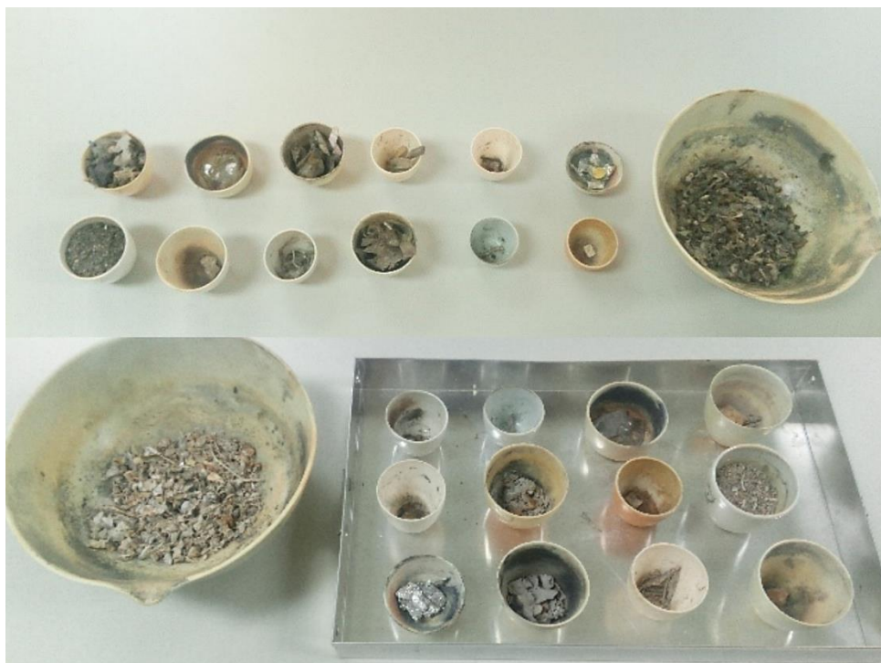
Slika 3.4.: Komponente reprezentativnog uzorka prije i nakon žarenja
