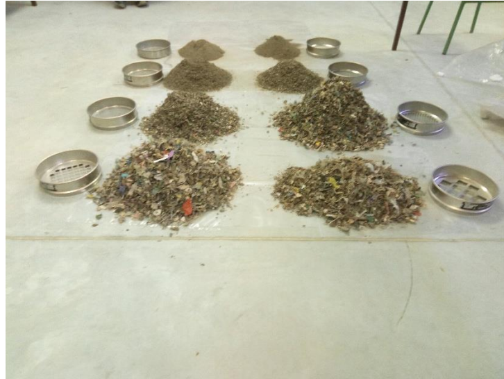
Slika 16. Dobivene frakcije nakon prosijavanja
