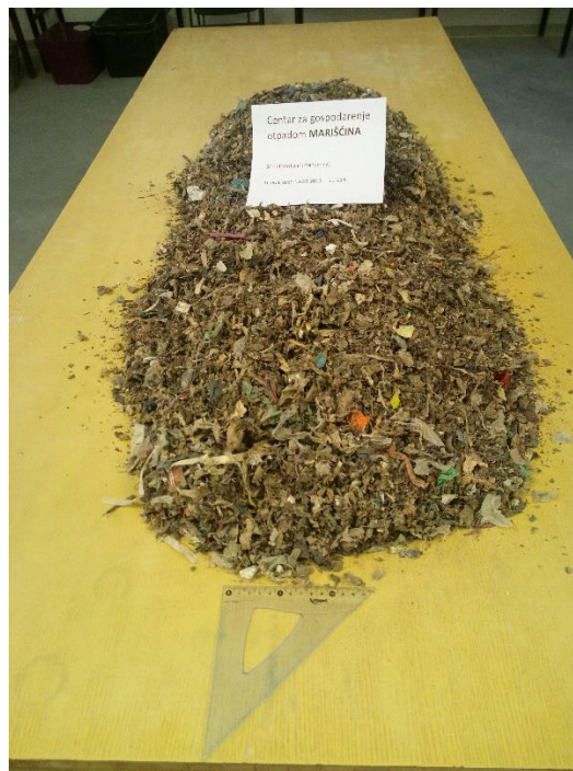
Slika 15. Uzorak MBO otpada
