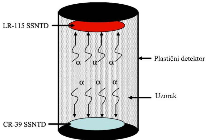
Slika 9. Prikaz plastičnog detektora nuklearnih tragova [23]
