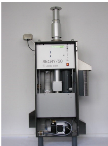
Slika 20. Prikaz mjernog uređaja Leckel SEQ47/50
