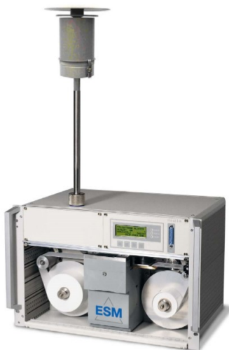
Slika 17. Prikaz mjernog uređaja Thermo Andersen ESM FH 62 I-R
