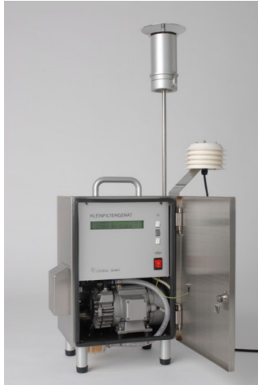
Slika 19. Prikaz mjernog uređaja LECKEL - LVS 3
