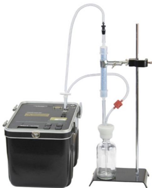
Slika 10. Uređaj RAD7 s dodacima za mjerenje radona u vodi [14]
