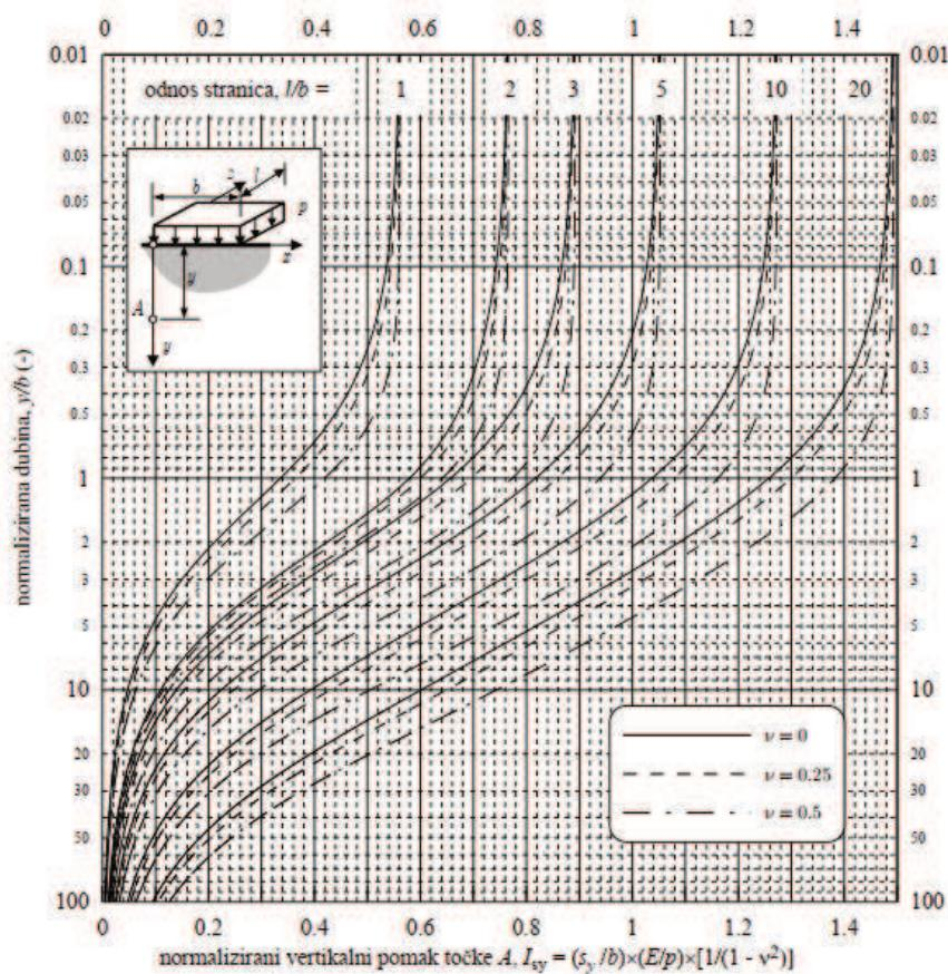
**Slika 7.** Utjecajni koeficijenti  $I_{sy}$  za vertikalnih deformacija rubne točke pravokutnog temelja prema Newmarku i Steinbrenneru (Szavits-Nossan, 2013)
