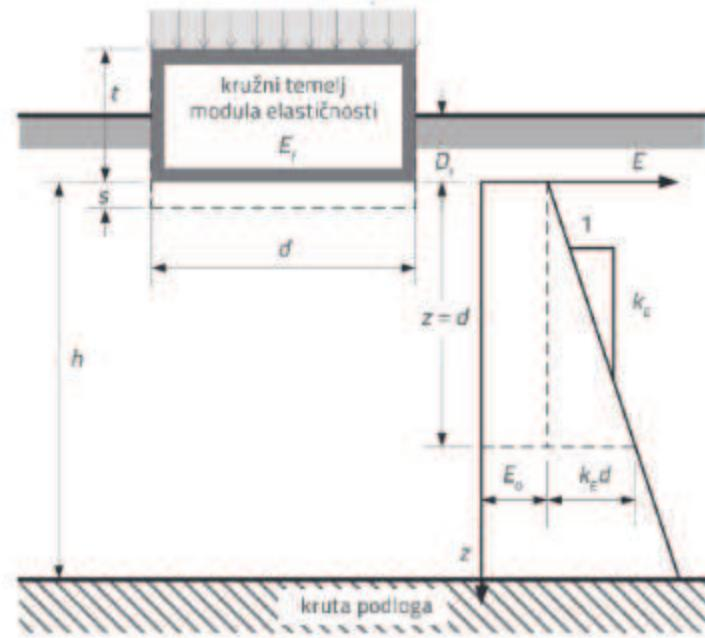
**Slika 6.** Slijeganje kružnog temelja ukopanog u sloj tla Gibsonove vrste (Lukić Kristić, Szavits-Nossan, Miščević, 2017)
