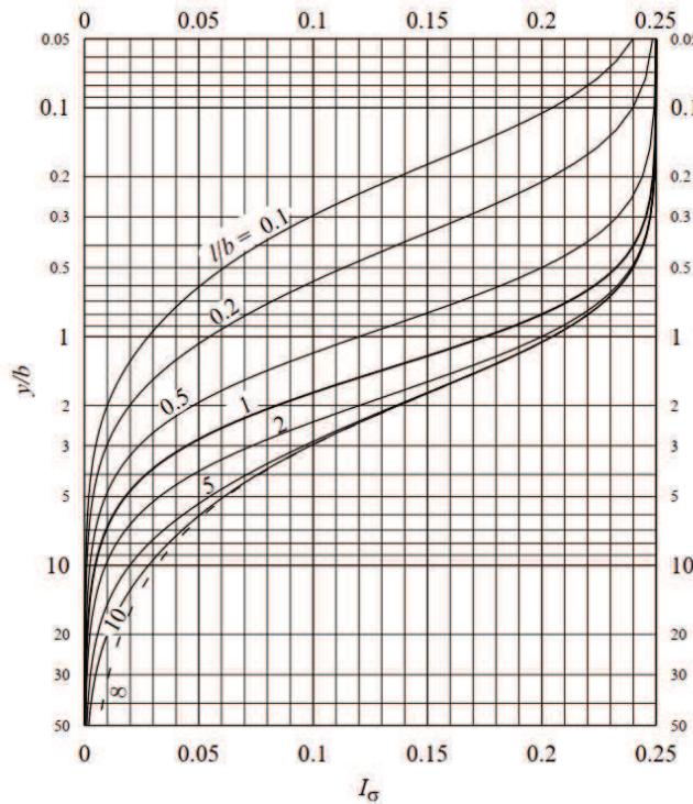
**Slika 8.** Utjecajni koeficijent  $I_\sigma$  za dodatno vertikalno naprezanje ispod vrha pravokutne plohe na površini linearno elastičnog, izotropnog i homogenog poluprostora opterećenog jednolikim vertikalnim opterećenjem (Szavits-Nossan, 2013)
