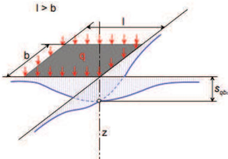
**Slika 5.** Aksonometrijski prikaz slijeganja ispod ugla pravokutno opterećene površine
