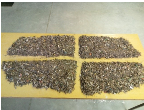
Slika 14. Odabir reprezentativnog uzorka, metodom četvrtanja
