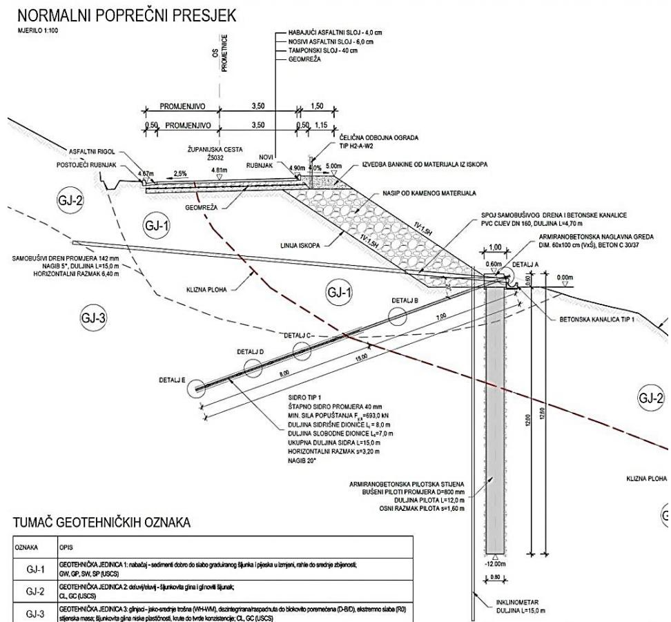
**Slika 30. Normalni poprečni presjek mjera sanacije klizišta**
