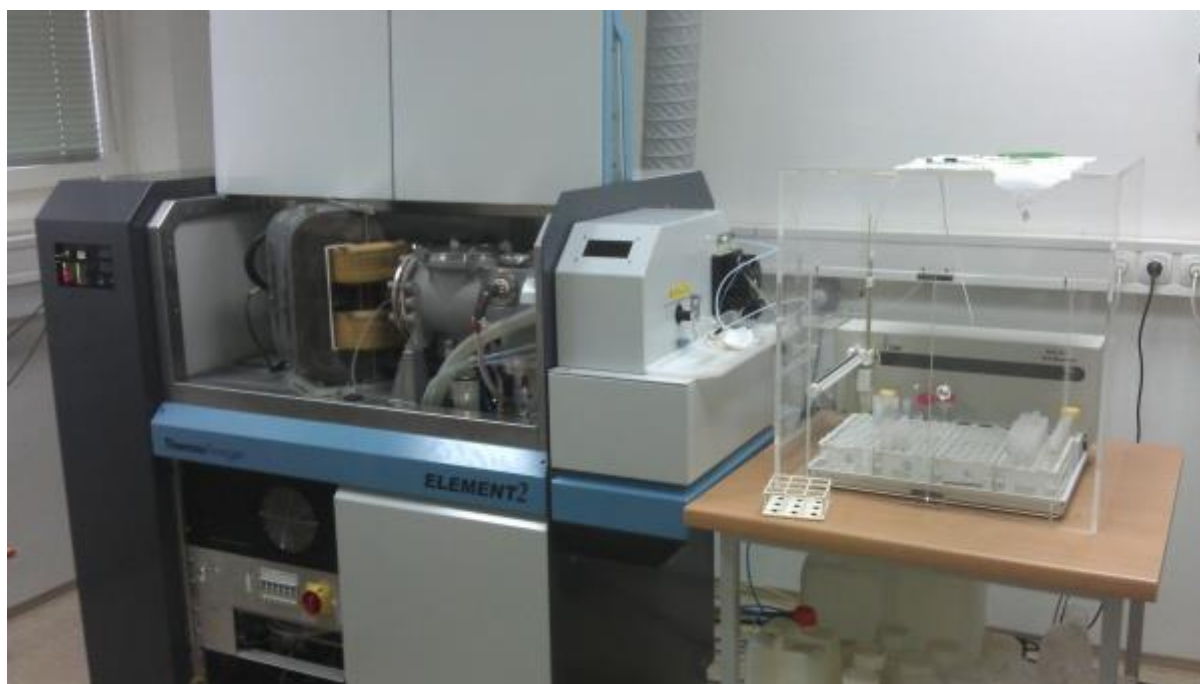
Slika 2. HR ICPMS - maseni spektrometar visoke rezolucije s induktivno spregnutom plazmom, Element 2 Thermo [11].
