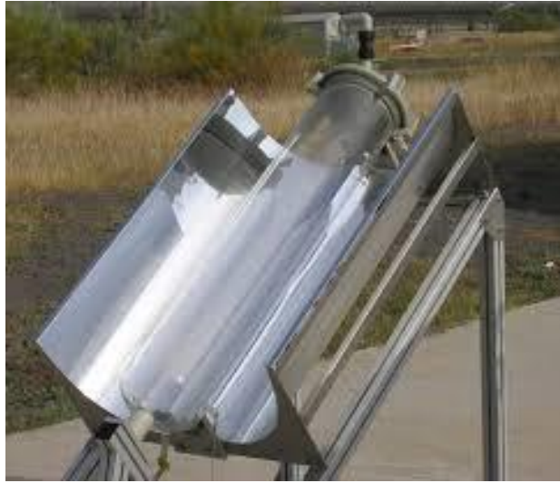
Slika 18 „CPC – SODIS“ fotoreaktor [61]
