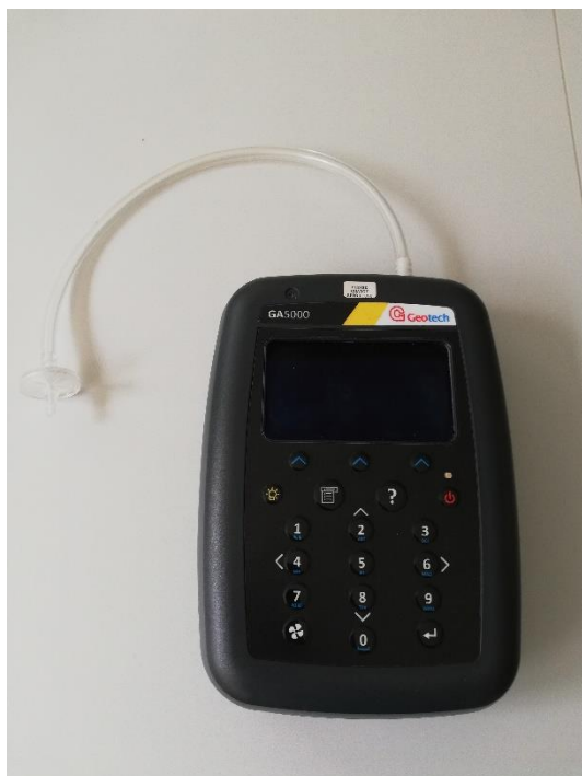
Slika 32 Uređaj za mjerenje plinova Geotech GA5000
