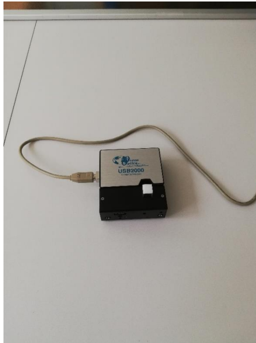
Slika 30 Prijenosni spektrofotometar Ocean Optics USB2000+
