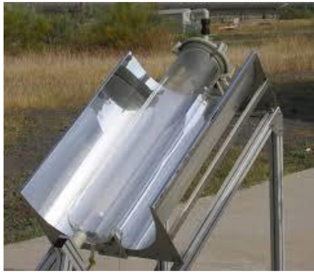
Slika 18 „CPC – SODIS“ fotoreaktor [61]
