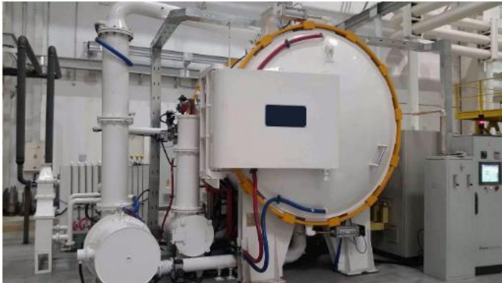
Slika 3 Vakuumska horizontalna jednokomorna peć [6]
