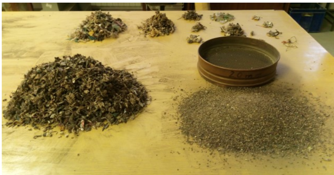
Slika 10: Uzorak iz ŽCGO Mariščina razdvojen na komponente
