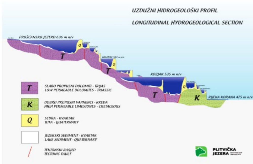
Slika 7. Uzdužni hidrogeološki profil. Izradio JUNPPJ. (Plitvička jezera, 2019.)
