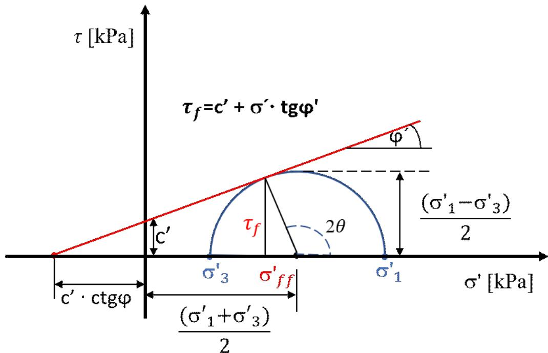
Slika 10. Mohr-Coulombova kružnica naprezanja i anvelopa sloma [9]
