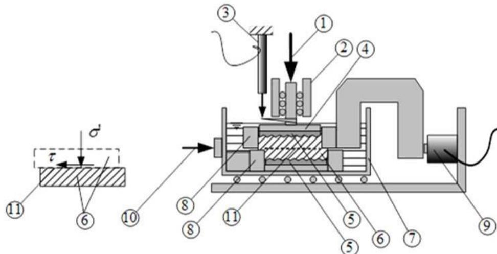
**Slika 14.** Dijelovi uređaja za izravni posmik [13]
