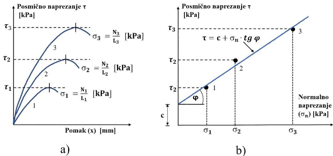
Slika 16. Dijagrami rezultata ispitivanja izravnog posmika [14]
