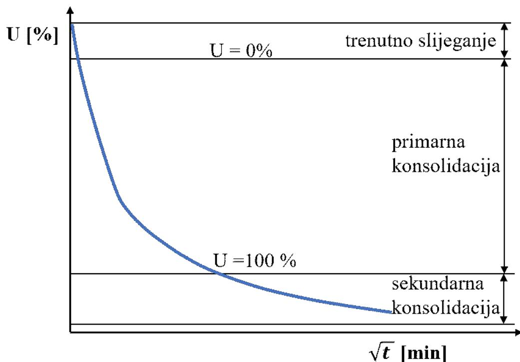
**Slika 7.** Krivilja vremenskog toka slijeganja, ovisnost stupnja konsolidacije U o proteklom vremenu t u mjerilu drugog korijena [3]
