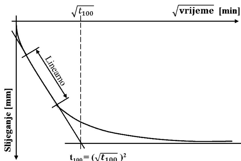
**Slika 18.** Grafički način određivanja vremena  $\sqrt{t_{100}}$  [6]
