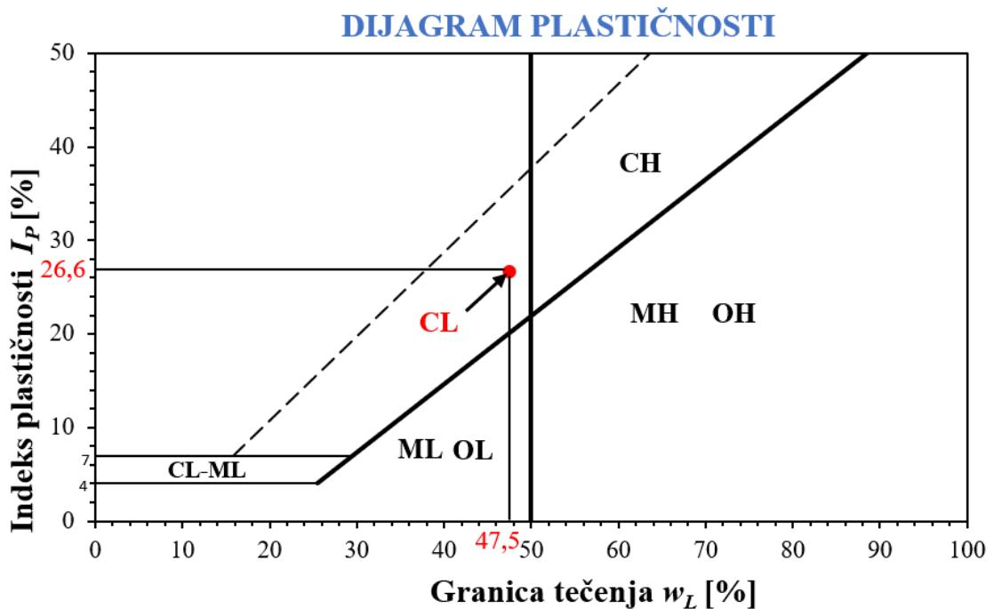
**Slika 21.** Dijagram plastičnosti uzorka tla za laboratorijsko ispitivanje
