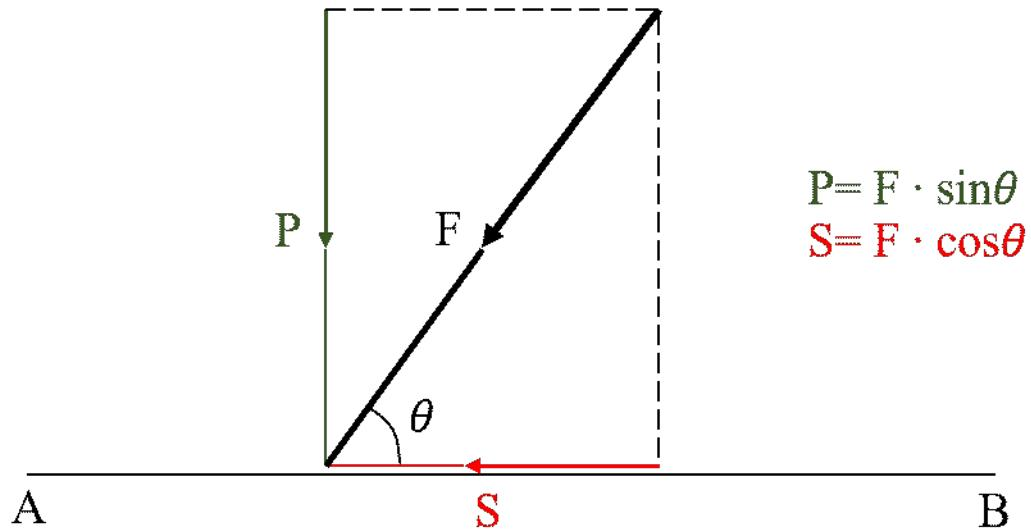
Slika 4. Rastavljanje sile na horizontalnu i vertikalnu komponentu [6]
