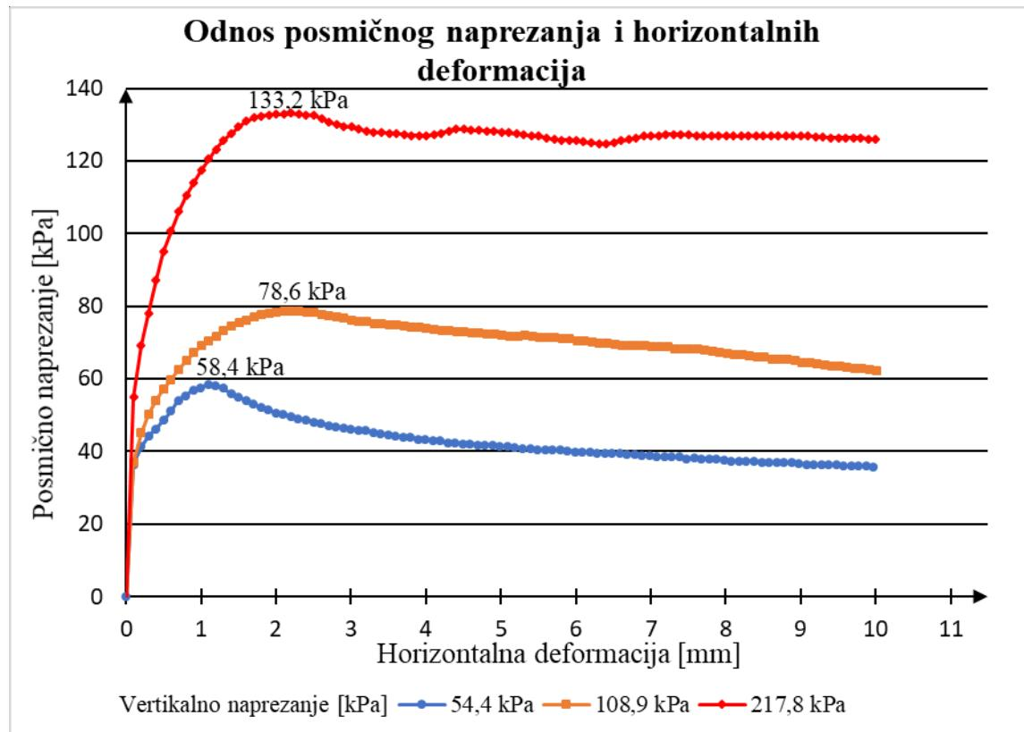
**Slika 32.** Odnos posmičnog naprezanja i horizontalnih deformacija kod brzine
