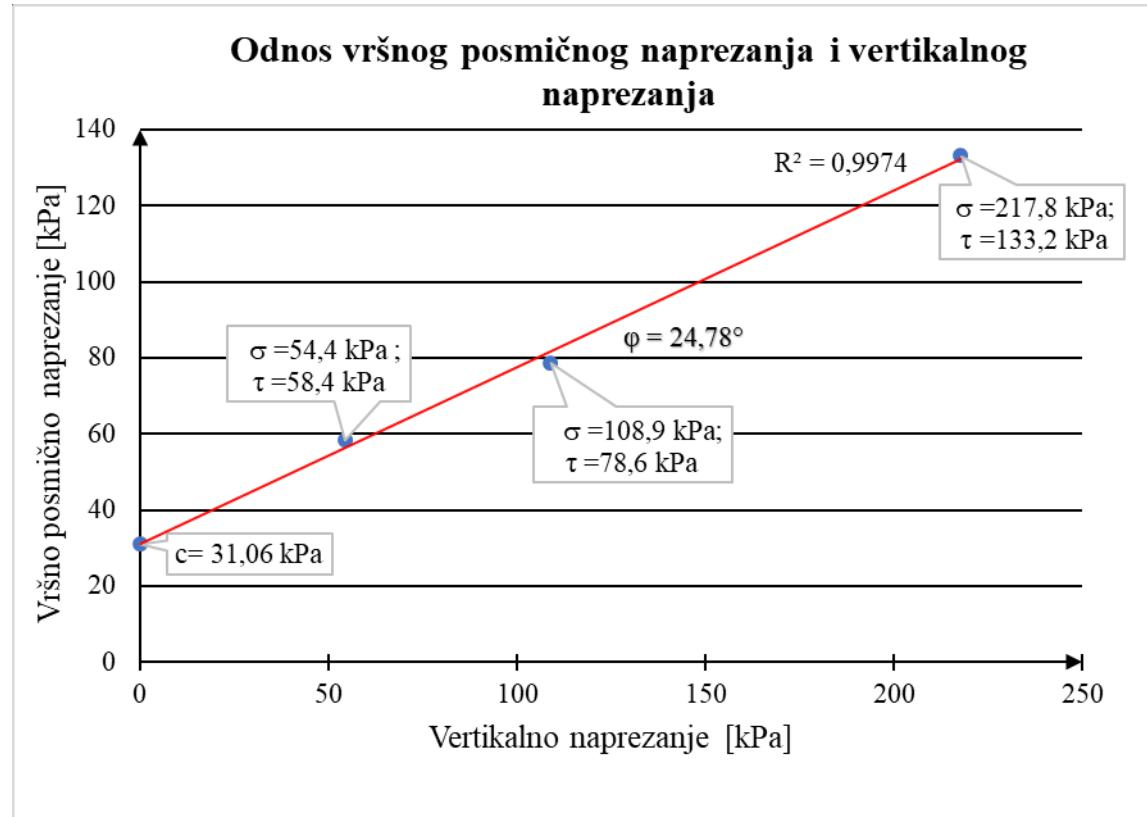
**Slika 33.** Odnos vršnog posmičnog i vertikalnog naprezanja kod brzine
