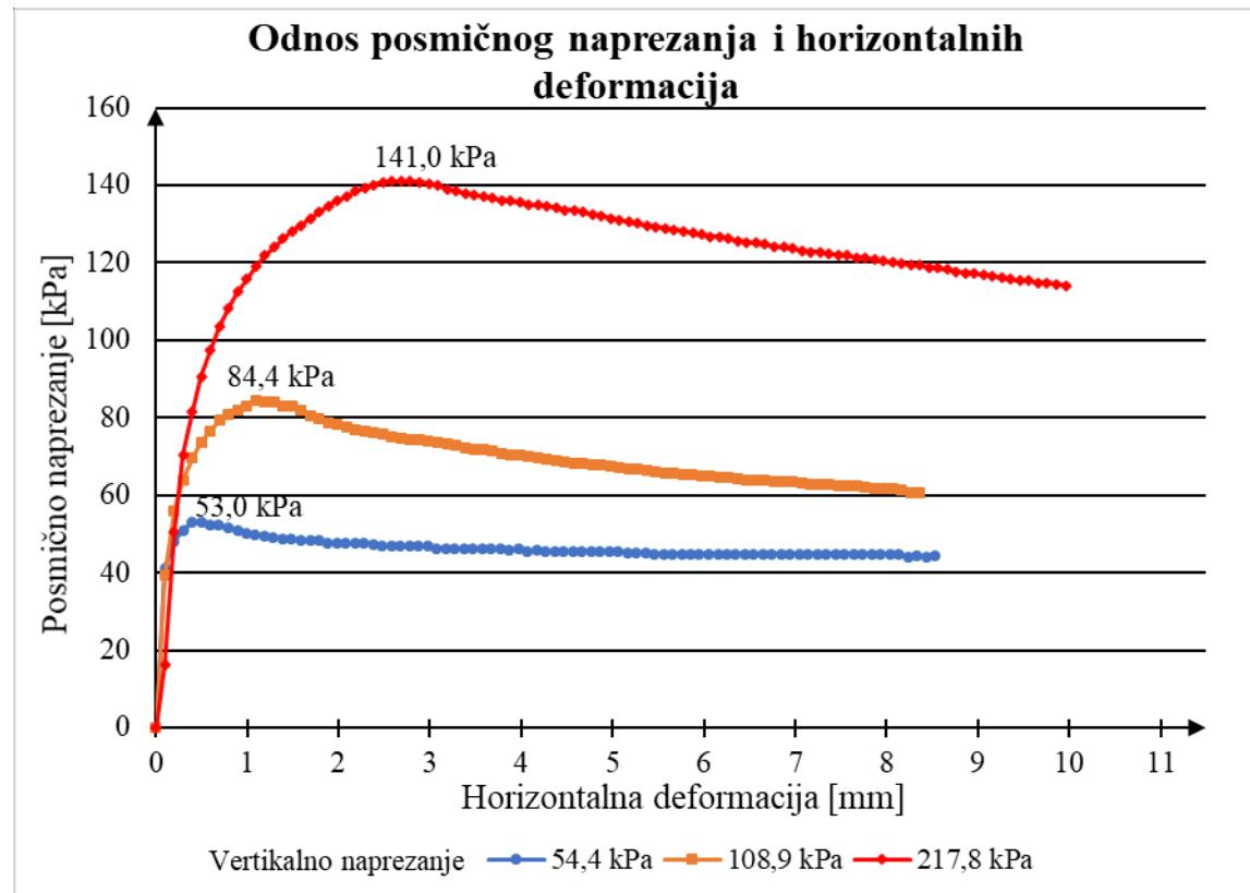
**Slika 30.** Odnos posmičnog naprezanja i horizontalnih deformacija kod brzine
