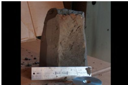
Slika 13 - Uzorak bloka stijene u laboratoriju prije isjecanja ispitnog uzorka [7]
