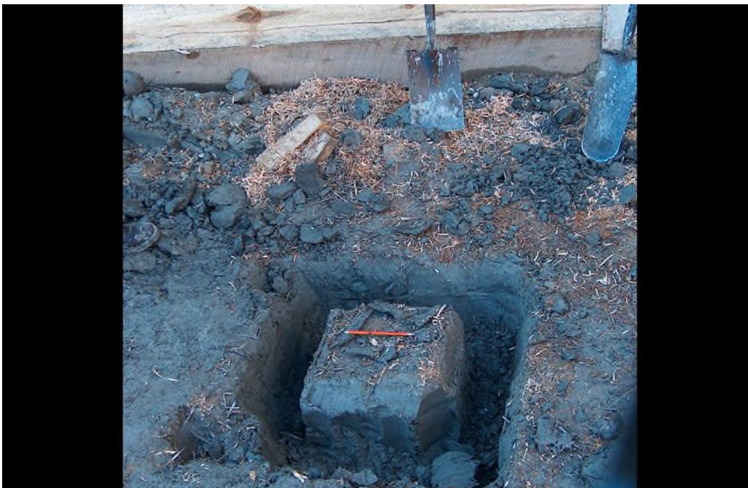
Slika 5 - Primjer neporemećenog uzorka koherentnog tla dobivenog isjecanjem bloka tla [7]
