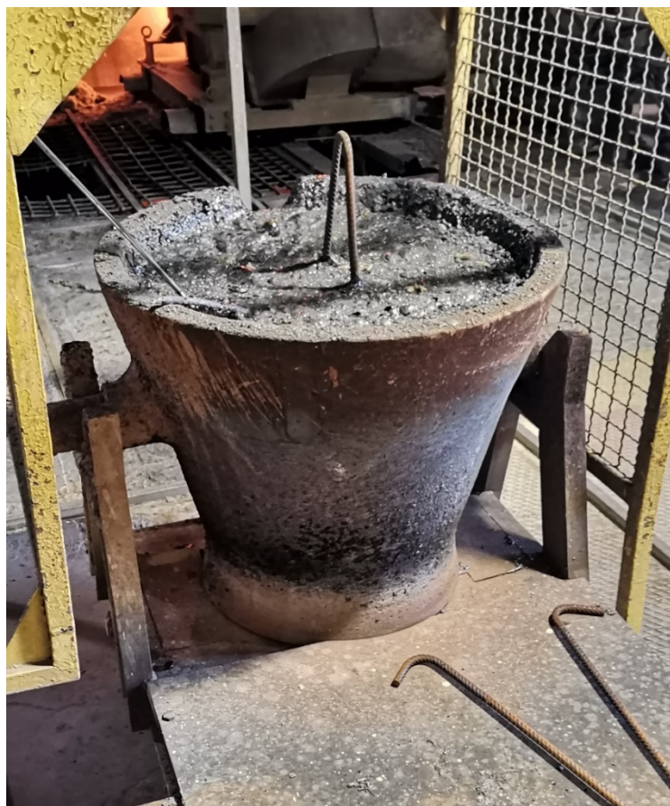
Slika 5. kalup za razlijevanja željeza
