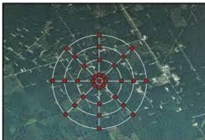
Slika 12. Metoda kontrolnog kružnog uzorkovanja [30]
