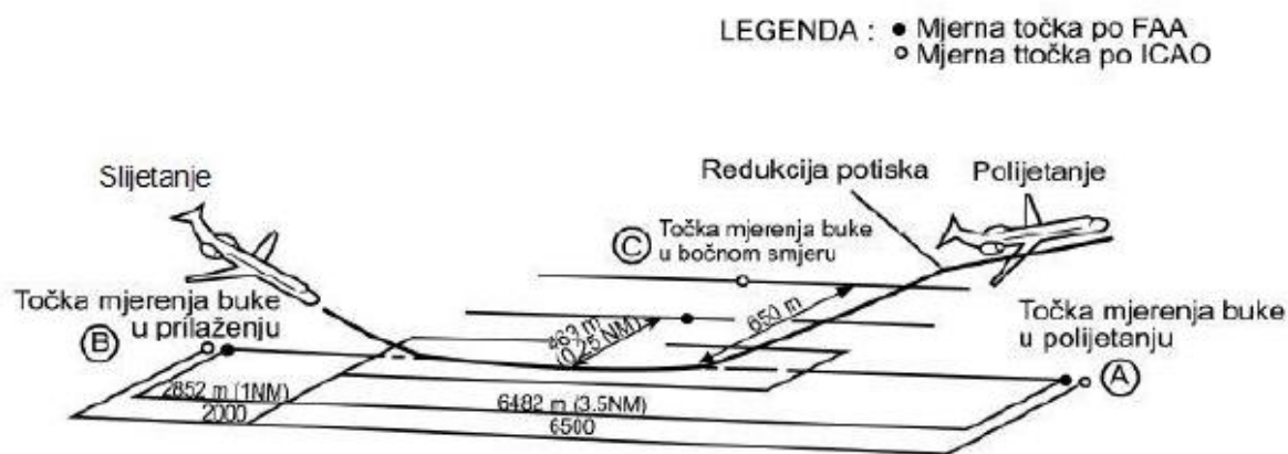
Slika 2: Referentne točke mjerenja razine buke zrakoplova pri slijetanju i polijetanju Izvor: [8]
