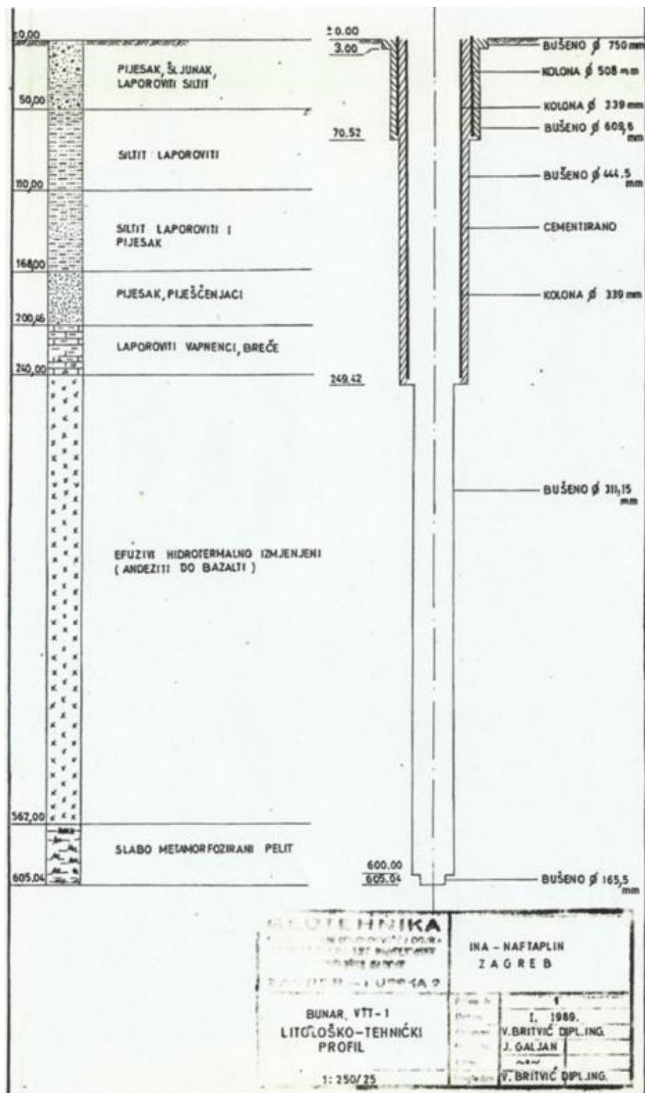
Slika 11 Litološko-tehnički profil bušotine VTT-1 (Škrlec, 2020)
