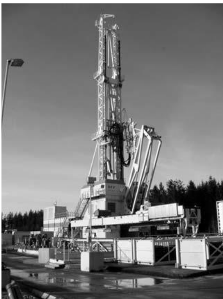
Slika 8 Bušača garnitura (Huenges, 2010)
