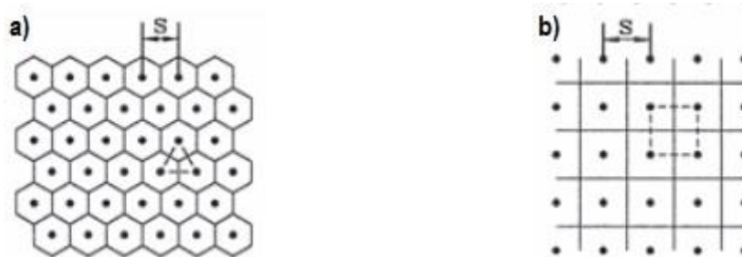
Slika 9. Raspored šljunčanih pilota: a) trokutasti b) pravokutni (prema Wang, 2009.)
