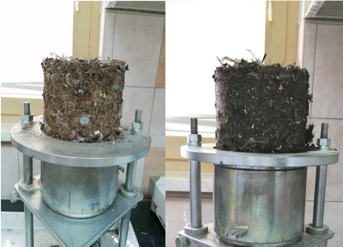
Slika 14 Zbijeni uzorak s 20% vlage (lijevo) i zbijeni uzorak s 40% vlage (desno)
