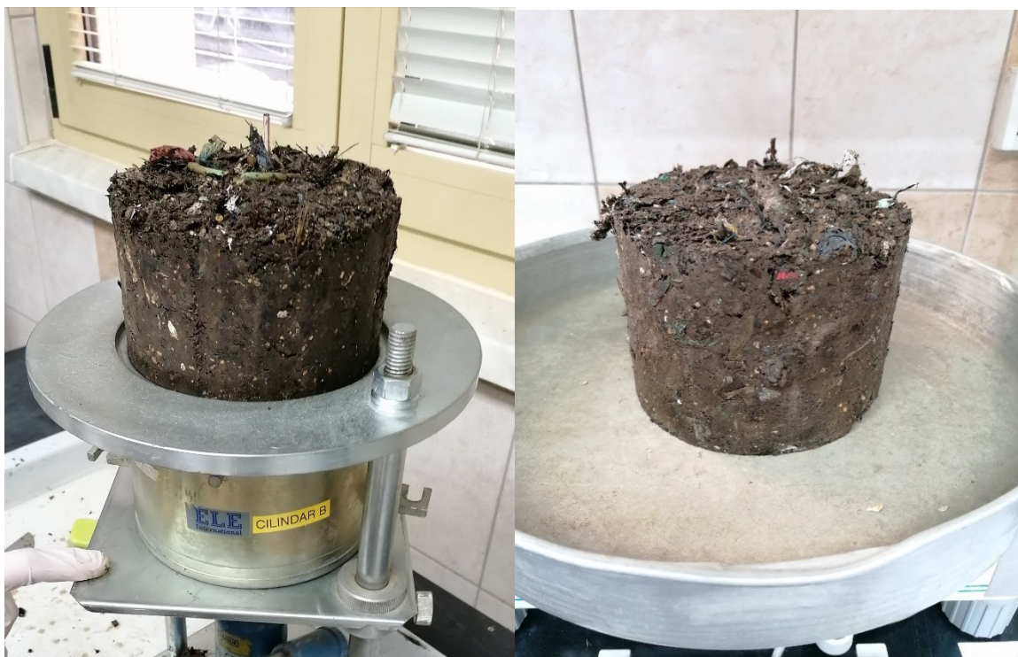
Slika 15 Zbijeni uzorak s 60% vlage (lijevo) i zbijeni uzorak s 80% vlage (desno)
