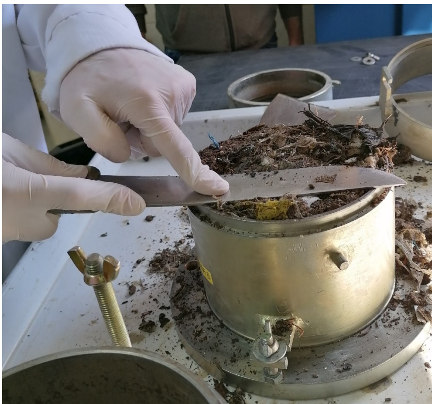
Slika 11 Poravnavanje zbijenog uzorka sa rubom cilindra
