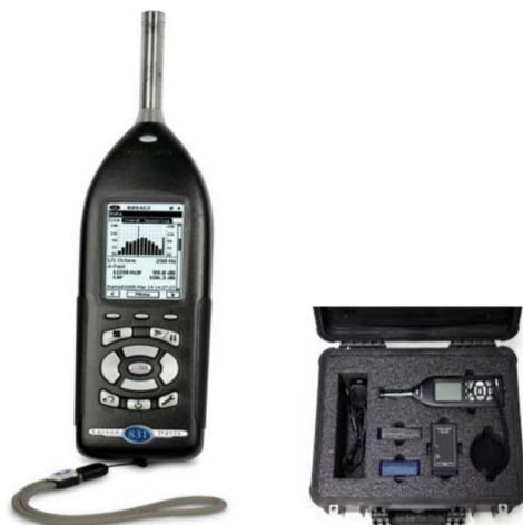
Slika 9. Uređaj za mjerenje buke (Larsondavis.com., 2017.)
